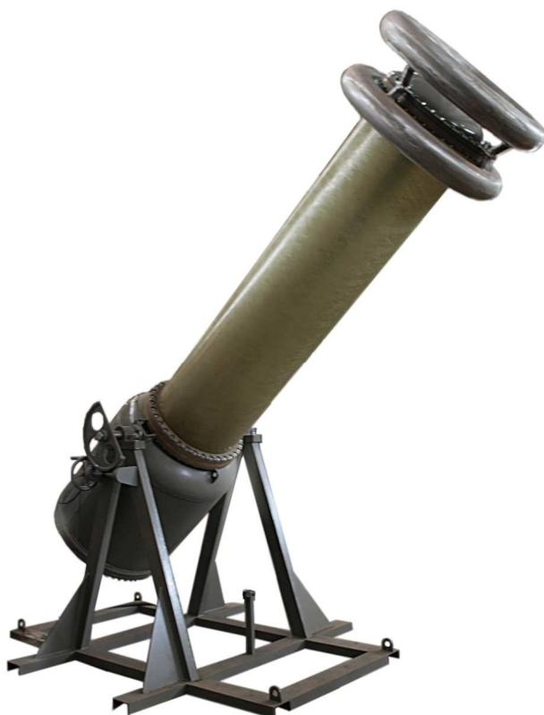
Испытательный однофазный газонаполненный трансформатор ИОГ-350-I (в дальнейшем - трансформатор) предназначен для испытания высоковольтного электротехнического оборудования кратковременным напряжением частоты 50 Гц, включая испытания с измерением емкости изоляции ( $C_x$ ), тангенса угла диэлектрических потерь ( $\operatorname{tg} \delta_{и}$ ) и частичных разрядов (ЧР).
